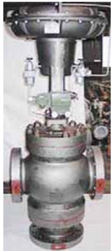
燃料ガス温度制御弁
