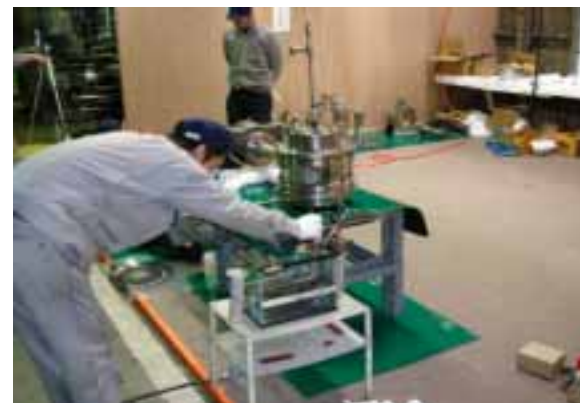
気密検査漏れ確認
