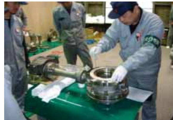
シート取付ボルト締め付け
