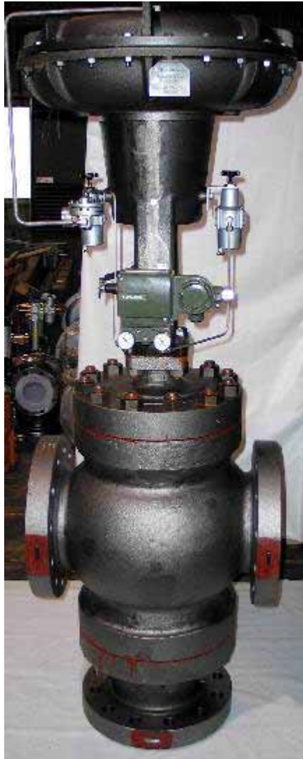
燃料ガス温度調節弁
