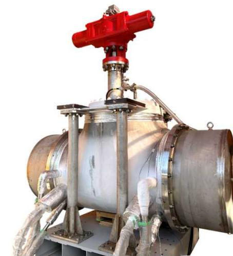
実液試験用大型試作品(800A, 32インチ)
