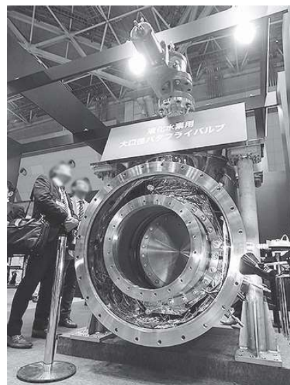
Sea Japan 2024に出展した口径800A (32インチ) の液化水素用大口径バタフライバルブ
