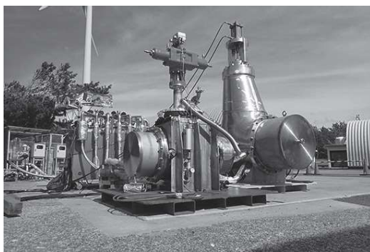
JAXA能代ロケット実験場での実液試験のようす。(左から)バタフライバルブ、グローブバルブ
